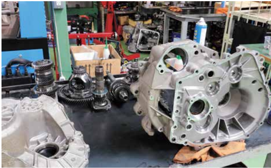
作業台上には分解された DSG のギア部分が置かれていた。入念にチェックして歯欠けなどの致命的なトラブルがなければ再度組み直して使用される。左写真の手前に映っている大きなパーツはハウジング。
