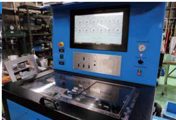
国内ではうしげ自動車しか備えている整備工場はないイギリス製バルブボディテスター。一般的なトルコン AT の心臓部にあたるバルブボディを単体でチェックできる優れモノ。
