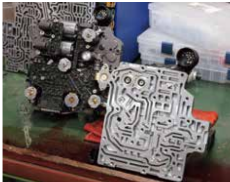
バルブボディ本体。分解すると内部はまるで迷路を思わせるような油圧回路となっている。この間に流れるオイルをコントロールすることで変速操作へとつなげる。
