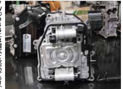
作業台上には分解された DSG のギア部分が置かれていた。入念にチェックして歯欠けなどの致命的なトラブルがなければ再度組み直して使用される。左写真の手前に映っている大きなパーツはハウジング。
