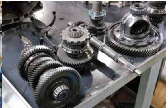
作業台上には分解された DSG のギア部分が置かれていた。入念にチェックして歯欠けなどの致命的なトラブルがなければ再度組み直して使用される。左写真の手前に映っている大きなパーツはハウジング。
